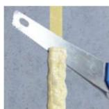
La schiuma indurita può essere tagliata con un coltello o rimossa meccanicamente (raschiatura). La superficie della schiuma espansa indurita deve essere protetta dai raggi UV utilizzando gesso o vernici.
