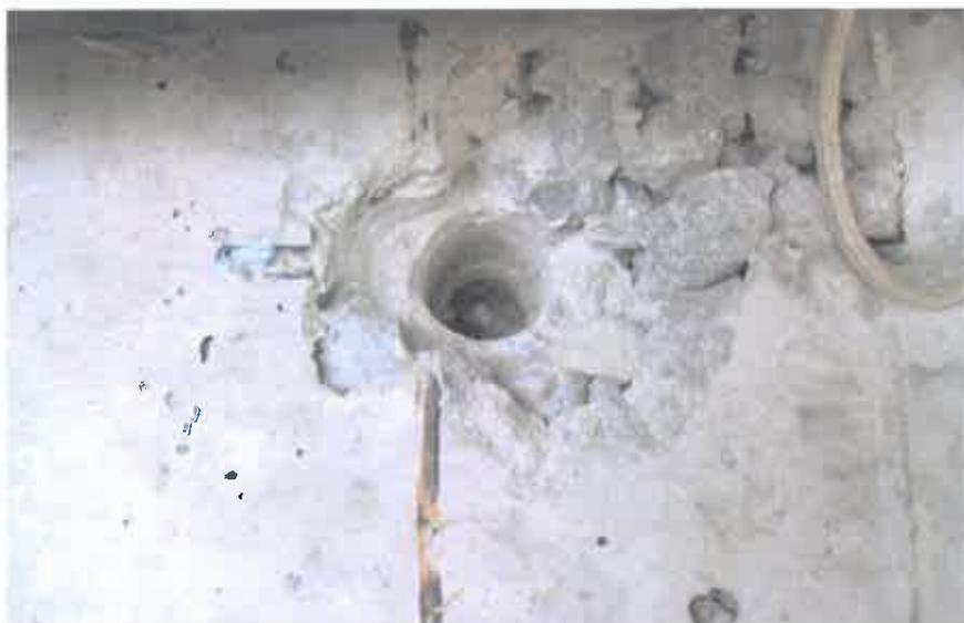
**Particolare della modalità di rottura a estrazione.**
