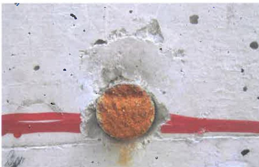
**Particolare della modalità di rottura a taglio.**
